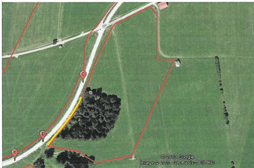
Bild 4: Ausschnitt aus Feld 2 mit Darstellung der Teilflächen, aus der Sonnenlicht zum Lokführer gelenkt wird: Gelbe Linie: Entlang dieser Linie müsste eine Abschirmung mittels Zaun oder Hecke erfolgen
